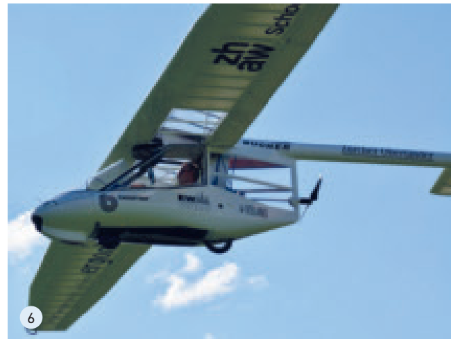
6: Der Archaopteryx Elektro entstand aus dem Fußstartsegler. Seine Segel-eigenschaften sind verbüffend und durchaus mit denen von Hochleistungs-drachen vergleichbar. Foto: Ruppert Composite
