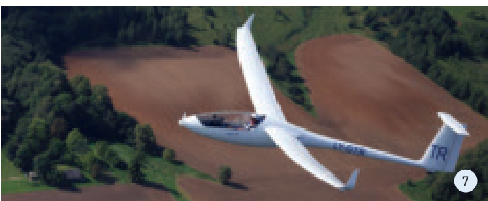
7: LAK 17B ist der erste FES-Selbststarter dank eines sehr hohen einziehbaren Fahrwerks, Der Antrieb kommt von LZ-Design. Foto: LAK Aircraft
